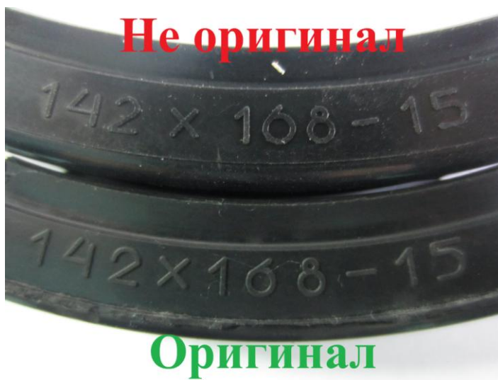
Фото №2.2. Межбуквенный интервал в маркировке с указанием манжеты по чертежу «65115-3104018 14x168-15»
