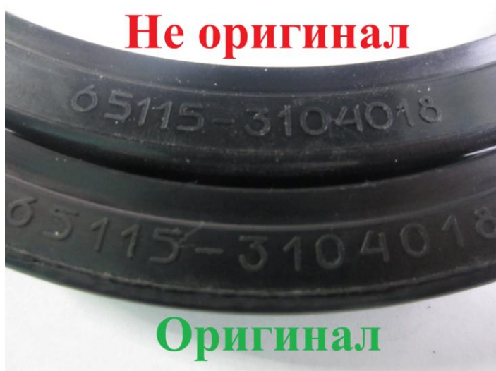
Фото №2.1. Межбуквенный интервал в маркировке с указанием манжеты по чертежу «65115-3104018 14x168-15»
